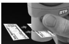
Para colocar la cinta, alinee los dos puntos (impresos en la cinta de réplica) con las flechas en ambos lados de la ranura de medición.
