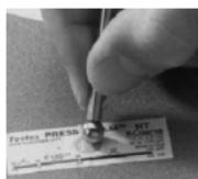
Drücken Sie den Replicafilm (Tape) fest mit dem abgerundeten Ende des beigefügten Glättwerkzeugs aus Edelstahl an, vorzugsweise im Kreisausschnitt. Wenden Sie ausreichend Druck in einer kreisförmigen und in x-y-Richtung durchgeführten Reibebewegung auf, um einen Abdruck mit einem gleichförmigen
