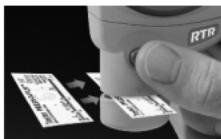
Pour positionner le ruban, aligner les deux points (imprimés sur le ruban de réplique) avec les flèches situées sur les deux côtés de l'ouverture de mesure.
