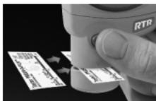
Richten Sie zur Positionierung des Replicafilms (Tape) die beiden (auf dem Replicafilm aufgedruckten) Punkte auf die Pfeile an den Seiten der Messöffnung aus.
